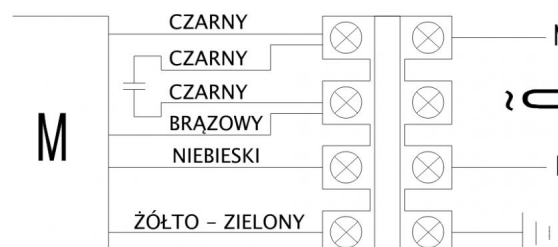
SCHEMAT ELEKTRYCZNY SILNIKA JEDNO-FAZOWEGO
