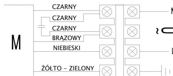
SCHEMAT ELEKTRYCZNY SILNIKA JEDNO-FAZOWEGO
