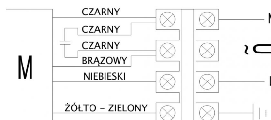
SCHEMAT ELEKTRYCZNY SILNIKA JEDNO-FAZOWEGO
