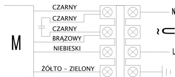
SCHEMAT ELEKTRYCZNY SILNIKA JEDNO-FAZOWEGO
