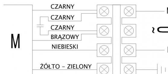
SCHEMAT ELEKTRYCZNY SILNIKA JEDNO-FAZOWEGO
