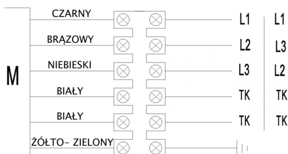
SCHEMAT ELEKTRYCZNY SILNIKA TRÓJ-FAZOWEGO
