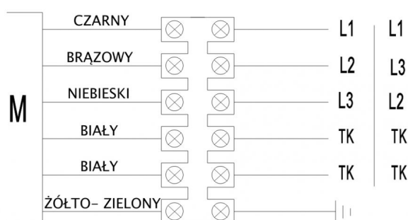
SCHEMAT ELEKTRYCZNY SILNIKA TRÓJ-FAZOWEGO
