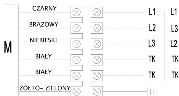
SCHEMAT ELEKTRYCZNY SILNIKA TRÓJ-FAZOWEGO
